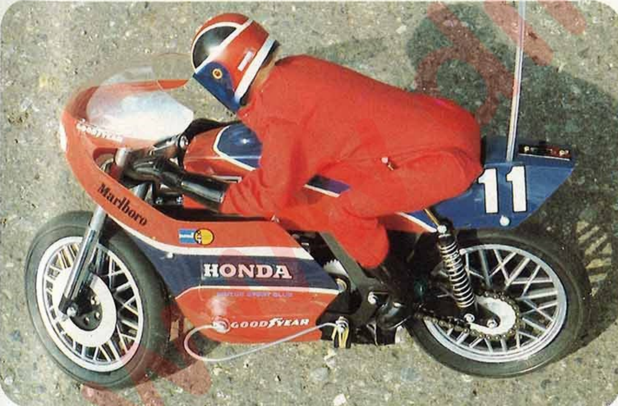
独自に開発されたクラッシュバーが付いているので、転倒しません。 傾斜したままの姿勢でもスタートができます。
